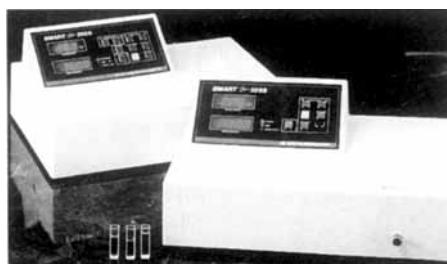
trationswerte von 0 bis 100 % durch Vergleich mit einer Referenzprobe. Verwendet werden  $10 \times 10 \text{ mm}^2$ -Standardküvetten.
